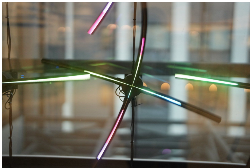
メカシャッターで撮影 (被写体は回転式ディスプレイ)
